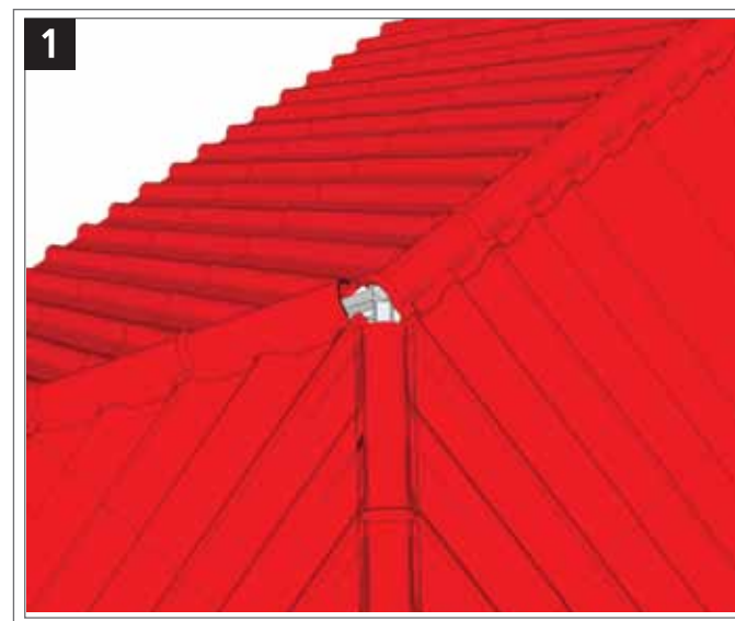
ภาพแสดงการตัดแต่งกรอบสันตะเข้บรรจบกับกรอบสันหลังคา
