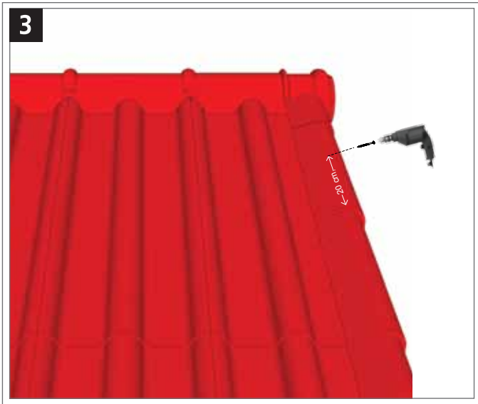
วางกรอบปิดหัวลงบนกรอบสันหลังคาจั่ว และให้ยึดด้วยสกรูเกลียวปลายสว่าน 4"
