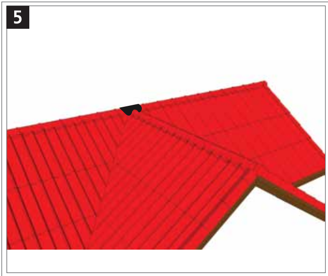
ให้ปิดทับด้วยแผ่นรองใต้กรอบบริเวณจุดที่กรอบสันหลังคา ทั้งสองด้านมาชนกัน เพื่อป้องกันการรั่วซึม
