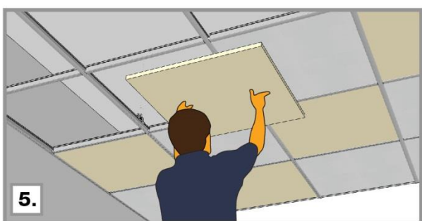
5. ยกแผ่นฝ้าทีบาร์ทีโพเข้าช่อง จากนั้นพลิกแผ่นฝ้าให้อยู่ระหว่างโครงฝ้าตามภาพ (เพื่อป้องกันการเกิดคราบดำหรือฝุ่นจับระหว่างยก ควรสวมใส่ถุงมือ หรือหากพบคราบต่างๆ ควรเช็ดด้วยน้ำและผ้าแห้งสีขาวทันที)
